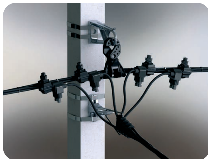
Noseće prihvatanje pomoću ES 1500 sa ocepom pomoću PC 4-150, FA 2, CA 1500 i PA 25
