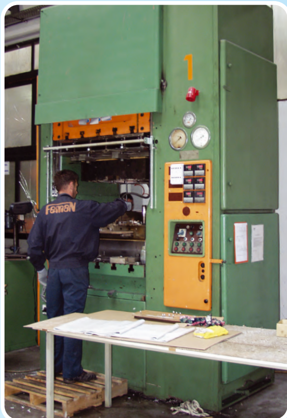
Pogon sa sedam vertikalnih savremenih hidrauličnih presa od 200 do 1000 tona.
